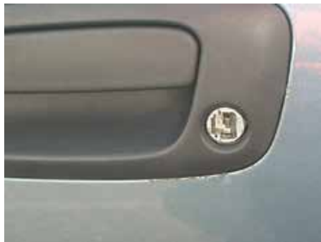
Niet acceptabel (niet gerepareerde inbraakschade)
