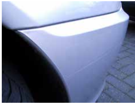
Acceptabel (lichte lakbeschadiging)
