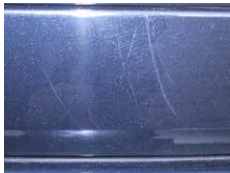
Acceptabel (oppervlakkige poetskrassen)
