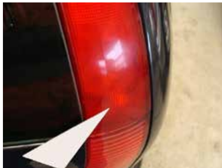
Niet acceptabel (barst in de lichtunit)
