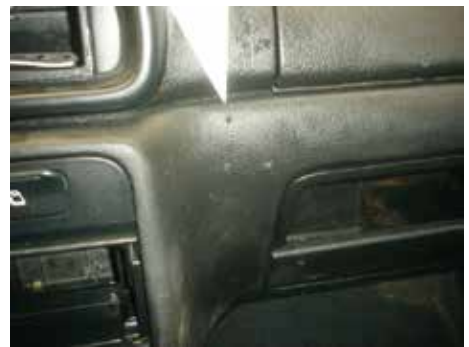
Niet acceptabel (gaten door gedemonteerde carkit)
