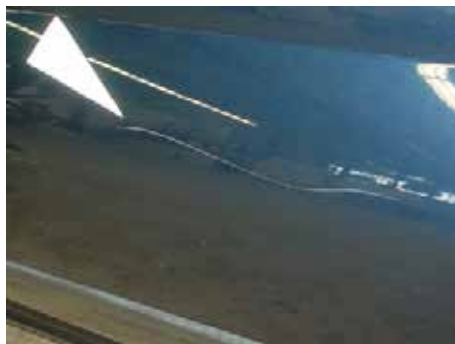
Niet acceptabel (kras door de lak heen)
