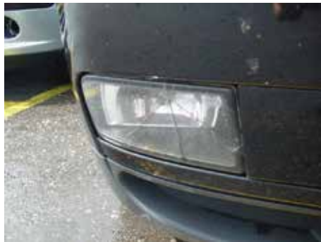
Niet acceptabel (scheur/barst in de lichtunit)
