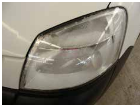
Acceptabel (condens in lichtunit; reflector niet aangetast)
